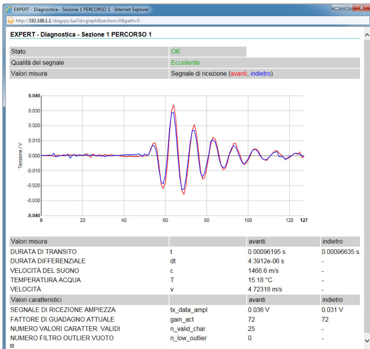
Figura 39: Diagnostica di percorso per misuratore RISONIC modular
